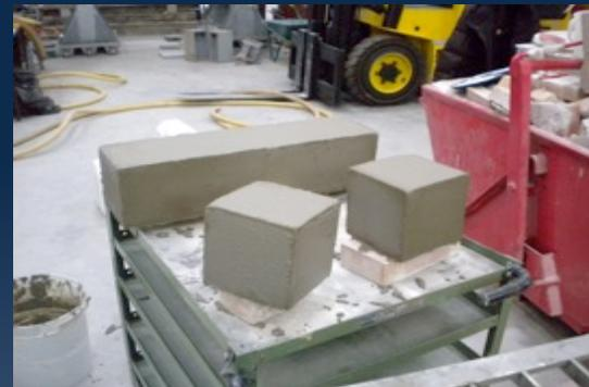
Immagini dei provini in calcestruzzo in preparazione (sinistra), protetti con la finitura acrilica AC 515 (provini chiari) e con la malta CM 519 (provini scuri) sottoposti a prova accelerata di resistenza alla carbonatazione.
